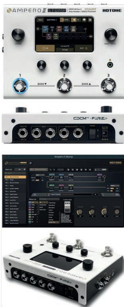
Y volviendo al tema de la función de interfaz de audio USB, el Ampero II Stomp una de 8 in/8 out, que en el tema grabación permite monitorear con efectos y grabar sin ellos, o grabar con y sin efectos a la vez, junto con la función de reamp, que viene siendo tendencia cuando de grabar guitarras se trata.
